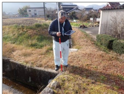
(GNSS基準点との比較:cm以内)
